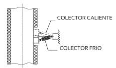
En la "sección longitudinal" se muestra como ha de fijarse el amortiguador a los amarres sin necesidad COLECTOR CALIENTE de quitar las tuercas. La distancia entre los casquillos puede ajustarse girando el tornillo y bloqueando la tuerca.
